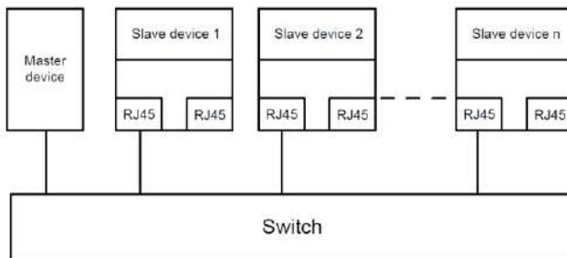
**A.6.6 Плата связи EtherNet/IP (EC-TX510) и плата связи Modbus TCP (EC-TX515)**
