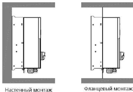
Рис 4.2 Способы установки
