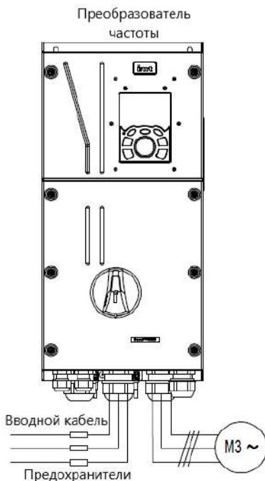
Рис 4.19 Подключение предохранителей
