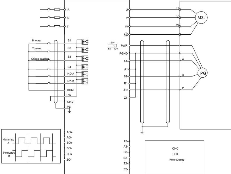
На следующем рисунке показана внешнее подключение платы расширения, используемой в сочетании с двухтактным датчиком.
