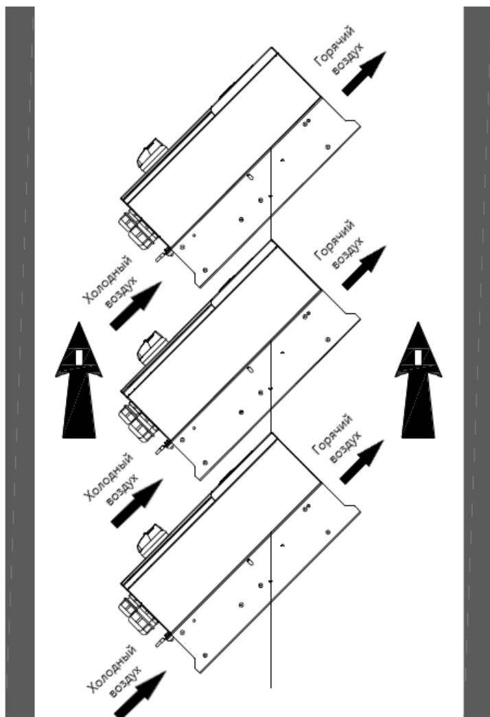
Рис 4.6 Наклонная установка
