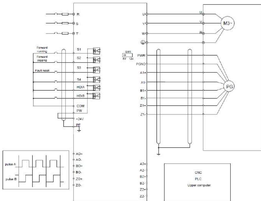
**А.7.5 Многофункциональная инкрементная PG-плата 24 В (EC-PG505-24В)**
