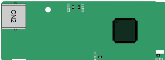
Для подключения платы связи EC-TX504 используется стандартные разъемы RJ45. Эта плата используется только для подключения ПЧ к ПК через программу INVT Workshop. Если вам необходим протокол Ethernet/IP, используйте плату EC-TX510.
