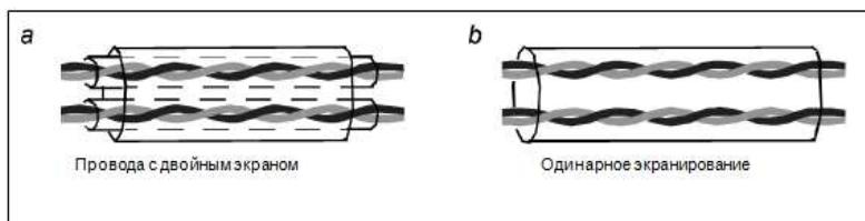
Для цифровых сигналов низкого напряжения рекомендуются кабели с двойным экраном, но также могут использоваться экранированные или неэкранированные витые пары (как показано на рисунке б). Однако для частотных сигналов можно использовать только экранированные кабели.
