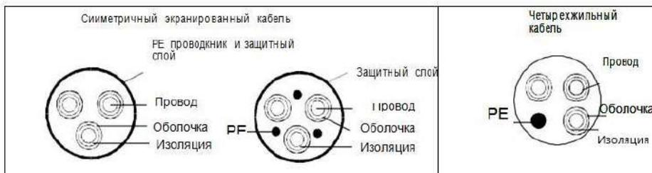
**Примечание:** Если проводимость экранирующего слоя кабелей двигателя не может соответствовать требованиям, необходимо использовать отдельные провода РЕ.
