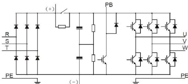
Рис 3.1 Схема силовой цепи моделей 015G/018P и ниже
