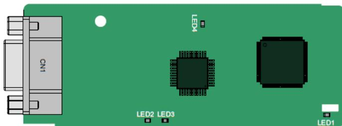
CN1 представляет собой 9-контактный разъем D-типа, как показано на следующем рисунке.
