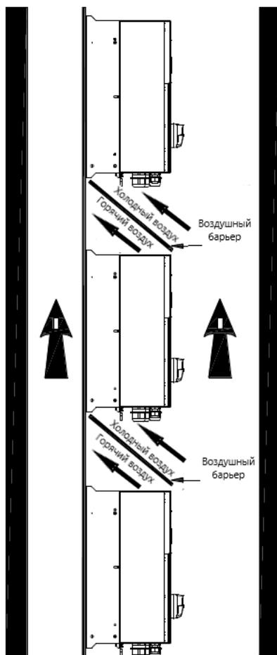
Рис 4.5 Вертикальная установка
