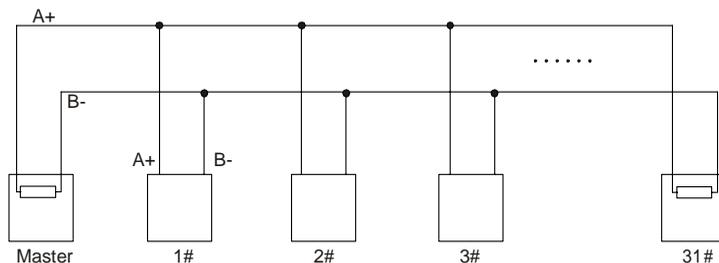
Рис 9.3 Упрощенная схема подключения по топологии «Шина»
