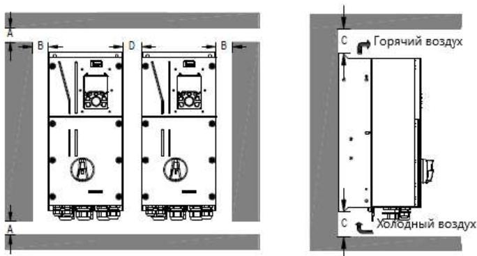
Рис 4.4 Параллельная установка
