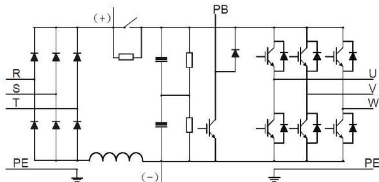
Рис 3.2 Схема силовой цепи моделей 018G/022P–110G (включительно)
