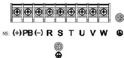
Рис 4.8 Силовые клеммы 004G/5R5P–5R5G/7R5P
