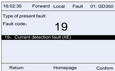
Рис 5.7 Состояние дисплея при сигнализации неисправности ПЧ
